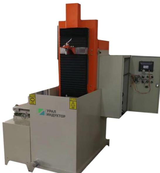
Рис. 8 – Установка сканирующей закалки УИ-600СЗ
