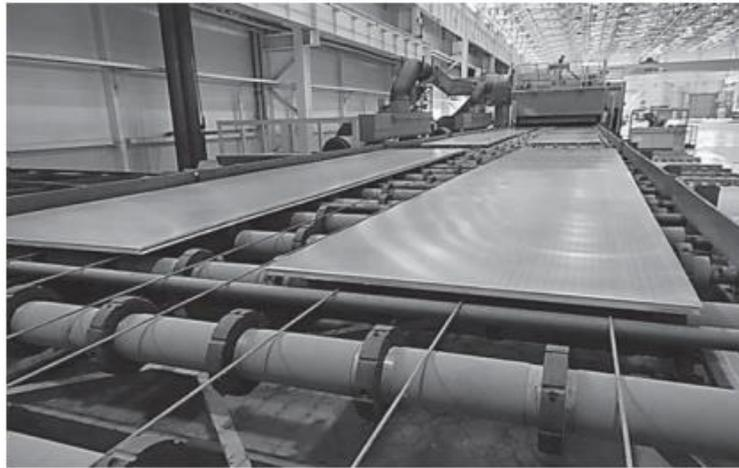
**Рис. 6 – Горизонтально – закалочный агрегат**
