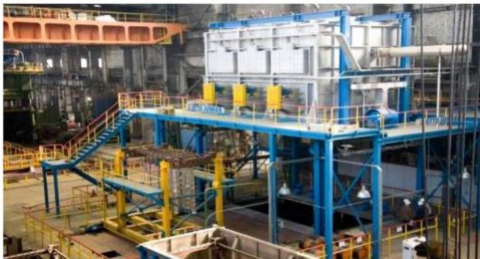
**Рис. 7 - Общий вид вертикального закалочного агрегата Otto Junker**
