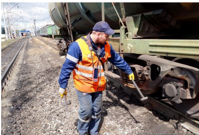
Рис. 2. Выявление дефектов осмотрщиком вагонов
