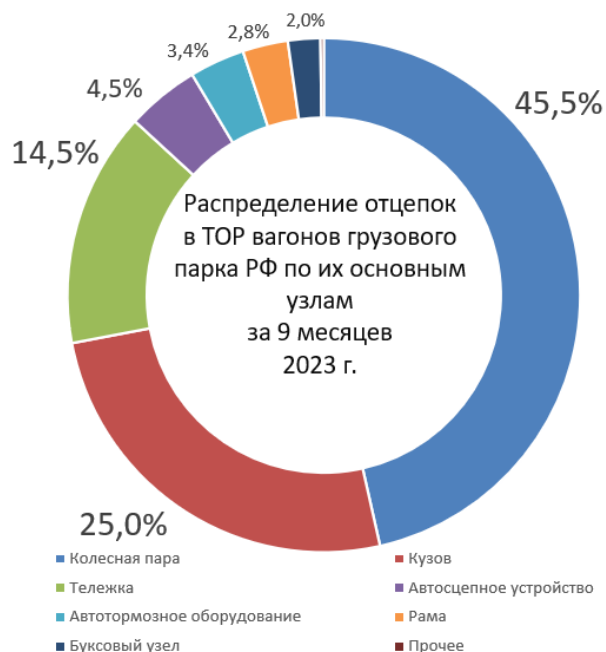
Рис. 1. Распределение отцепок в ТОП вагонов грузового парка РФ по их основным узлам за 9 месяцев 2023 года
