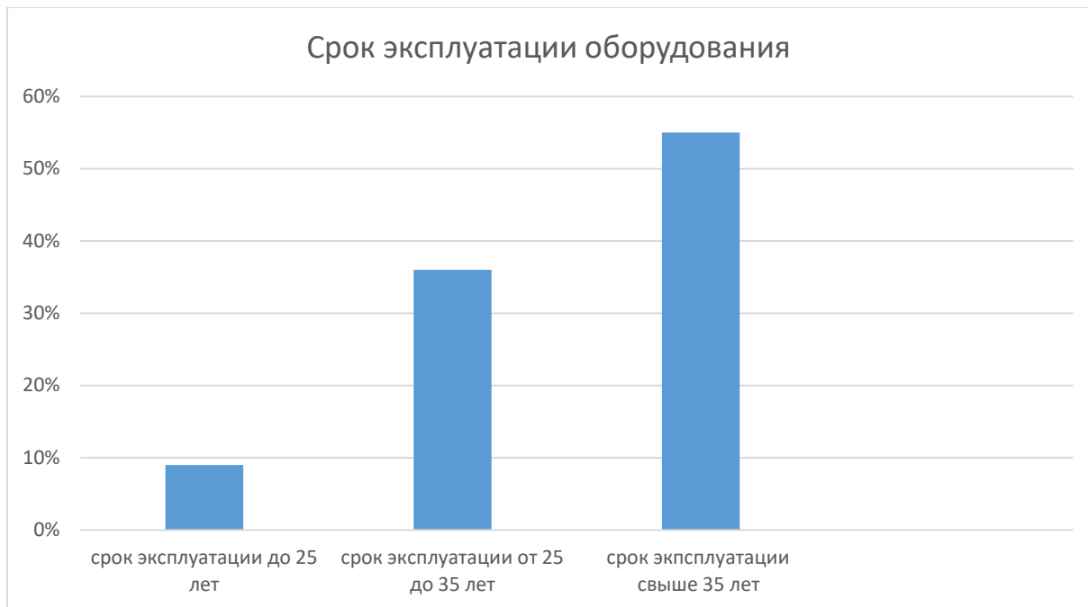
Рис. 2. Анализ сроков эксплуатации электрооборудования подстанции
