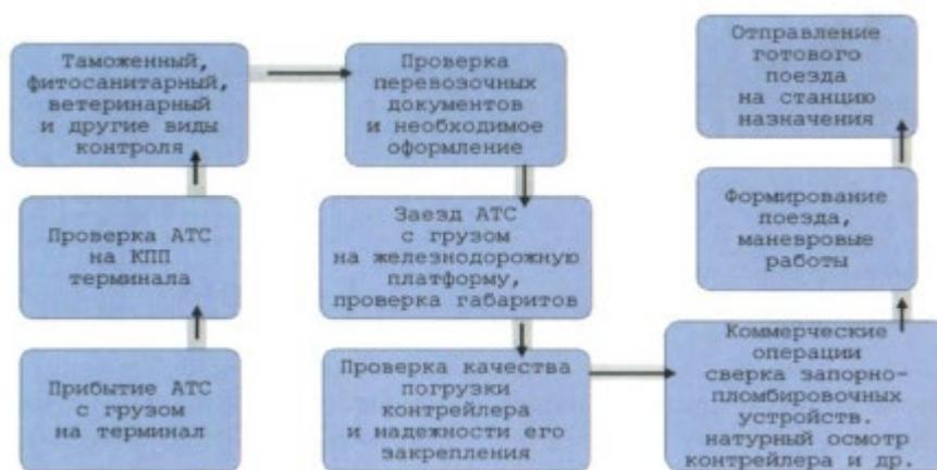
**Рис. 2. Порядок основных элементов контрейлерного терминала [9]**
