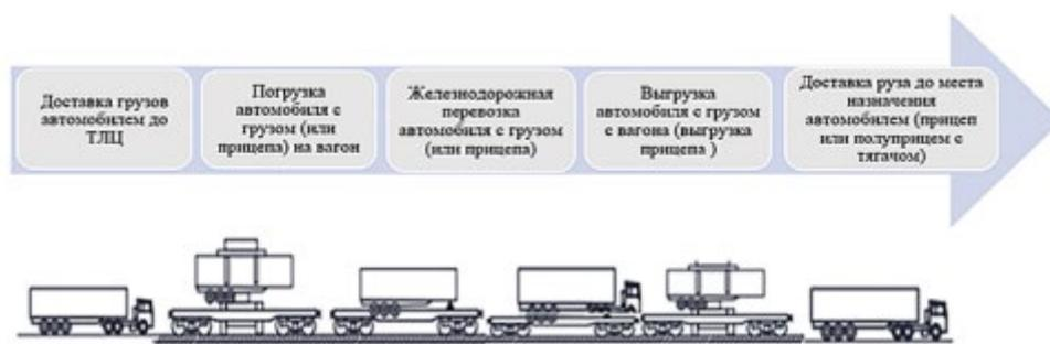
Рис. 1. Схема работы контрейлерного терминала по технологии «Lo-Lo»
