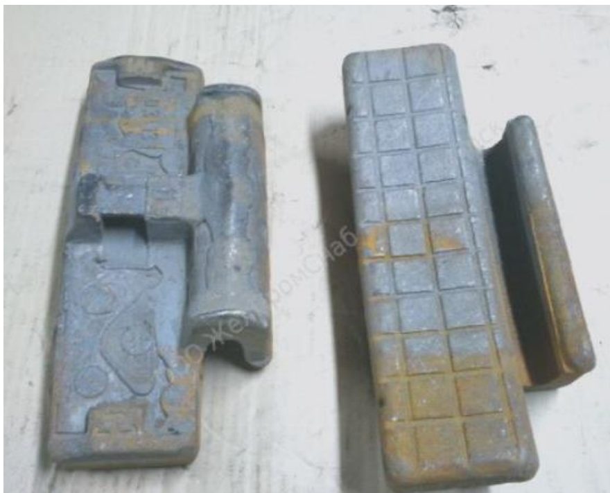
Рис. 1. Чугунная локомотивная тормозная колодка с глубоким зацепом
