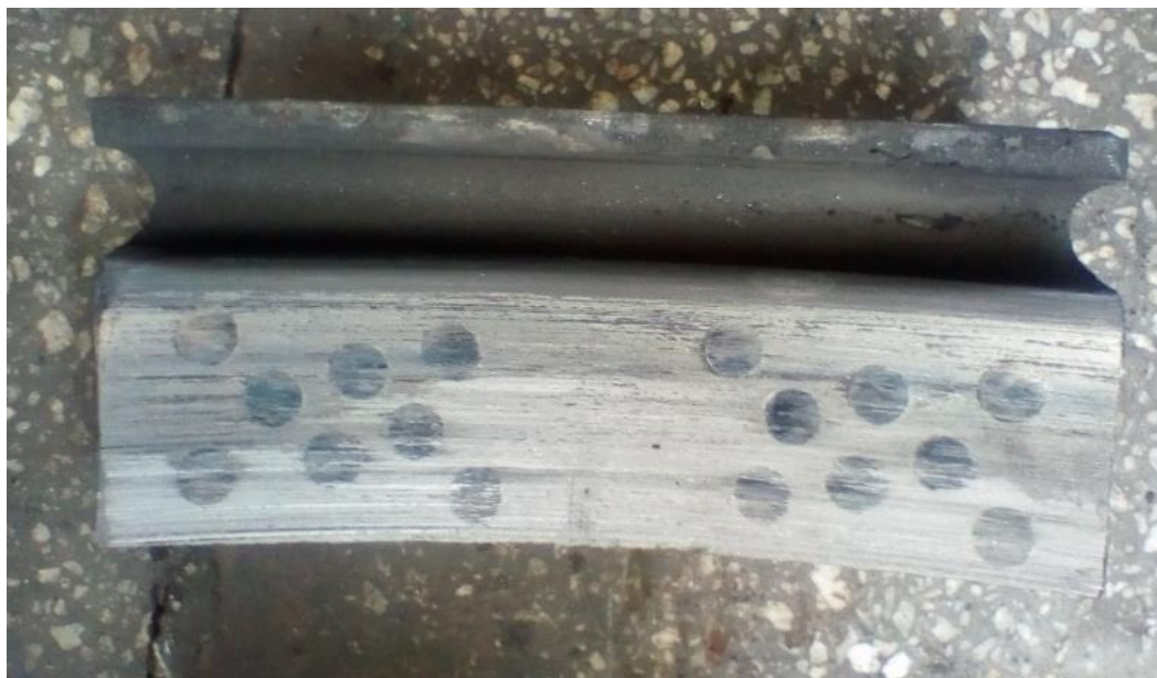
Рис. 3. Биметаллическая чугунная тормозная колодка «КОТЕ тип-02» с высоким зацепом на всю длину гребневой части
