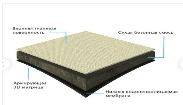
Рис 2. Устройство бетонного полотна Concrete Canvas
