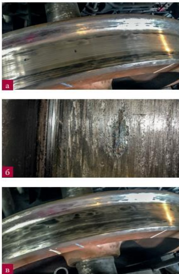
а – с металлокерамическими вставками, б – с чугунными вставками, в – со вставками из полимерного композита ТИИР-300
