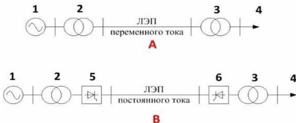
Рис. 1. Структурные схемы ЛЭП сверхвысокого напряжения:
