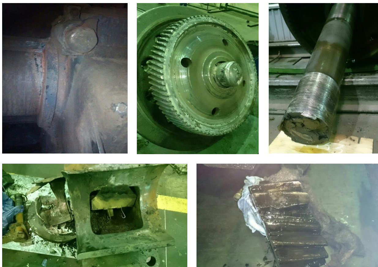
Рис. 4. Излом шейки оси колёсной пары электровоза, как результат «сухого» трения МОП скольжения электровоза
