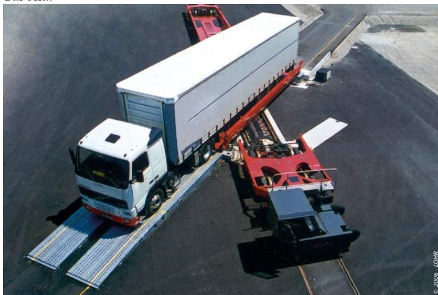
Рис. 4. Реализация способа погрузки Modalohr
