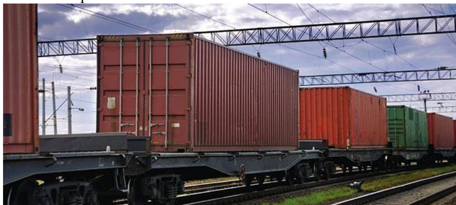
Рис. 1. Расположение контейнера на открытой платформе
