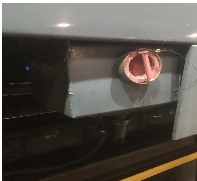
Рис. 2. Бункер пескоподачи головного вагона электропоезда РА2
