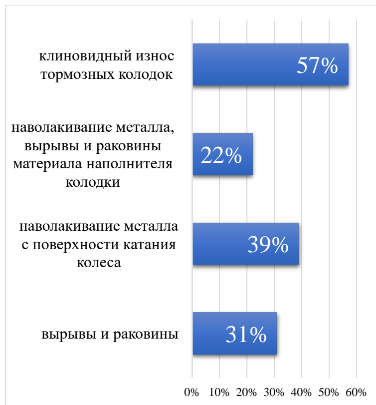
Рис. 1. Доля выявленных дефектов в процессе использования тормозных колодок в опытном поезде «РЖД-УВЗ-УрГУПС Мониторвагонтранс»
