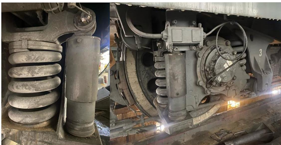
**Рис. 2. Расположение гидродемпфера в локомотиве 3ЭС5К**
