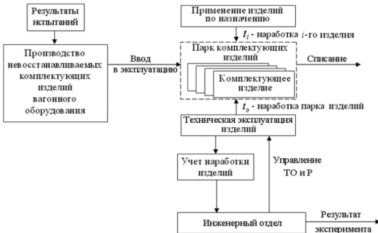
Рис. 4. Структурная схема статистической модели Системы технического обслуживания и ремонта грузовых вагонов
