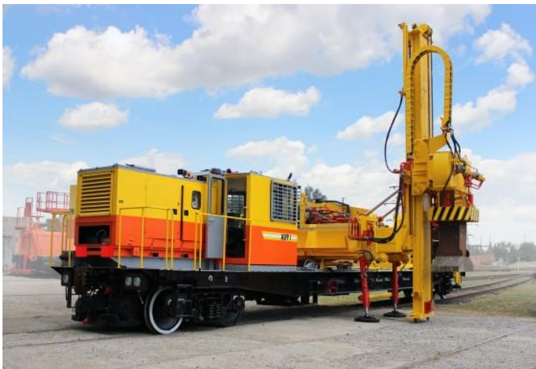
Рис. 6. Агрегат для вибропогружения свайных фундаментов АВФ-1М
