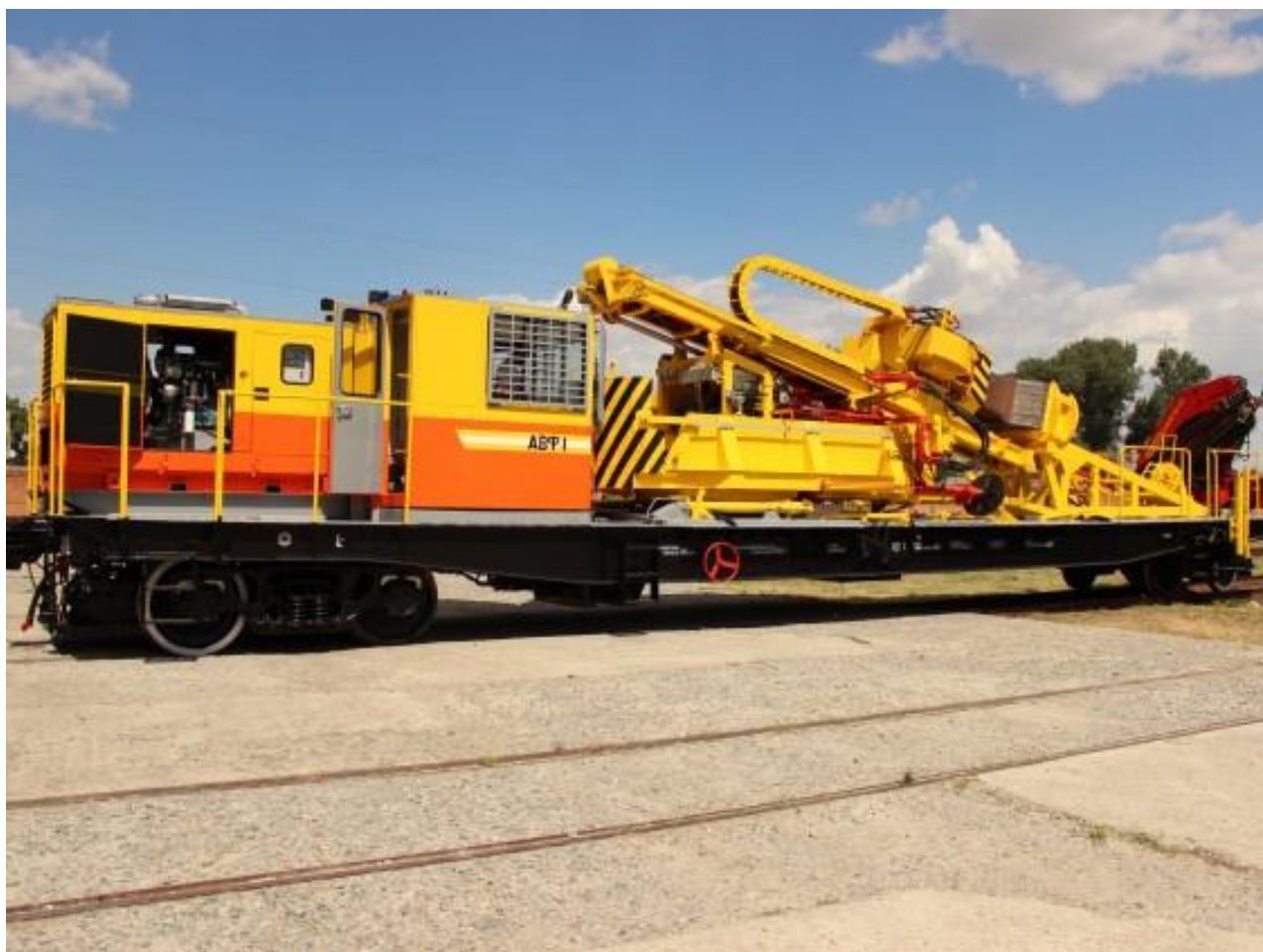
Рис. 5. Вибропогрузатель АВФ-1М для установки контактных мачт и опор мачт
