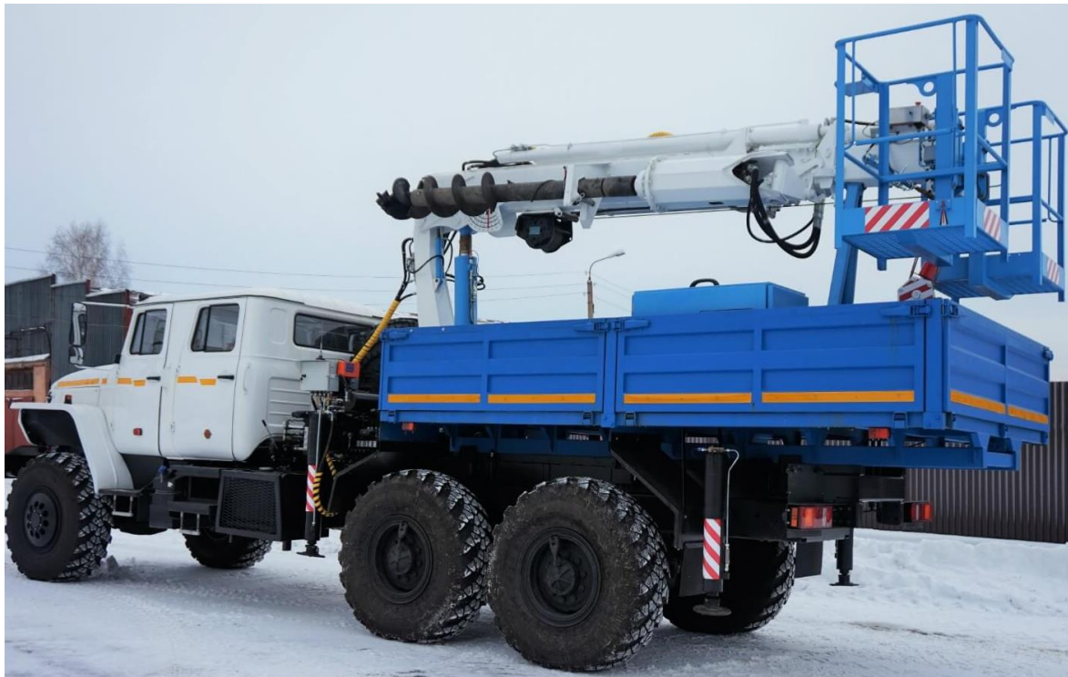
Рис. 3. Многофункциональные краны-манипуляторы МКМ-200
