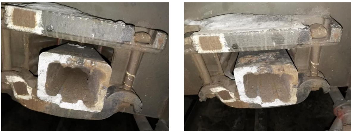
Рис. 2. Обрыв автосцепки на участке Утай-Тулун
