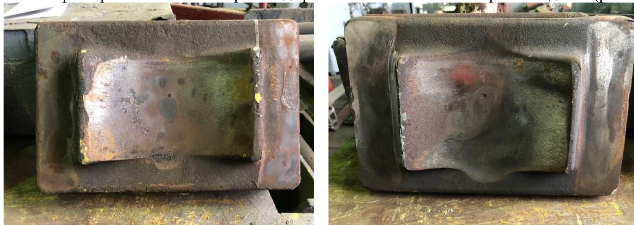
Рис. 1. Неисправность упорной плиты
