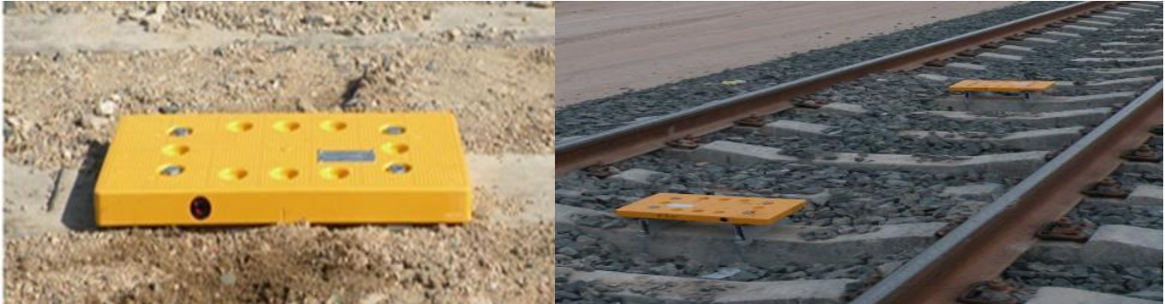
Рис. 5. Внешний вид установленной в путь балиссы
