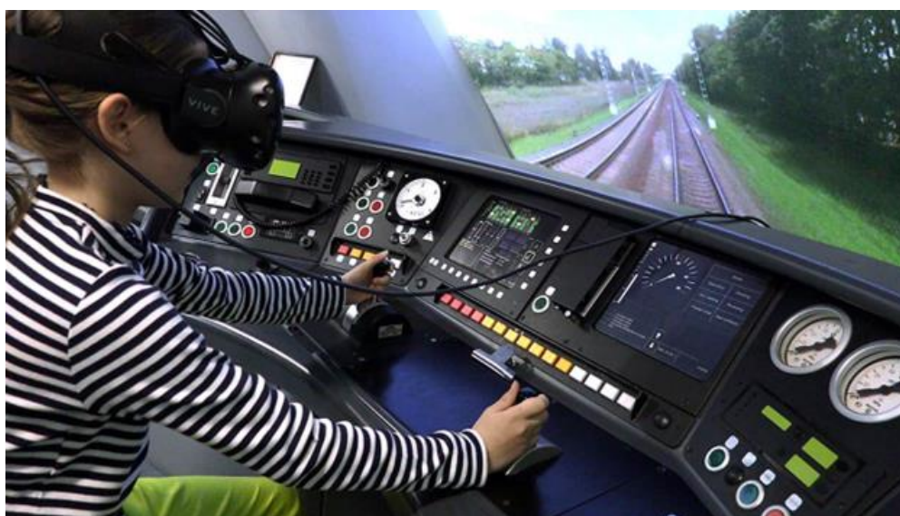
Рис.3. Пример работы на VR-комплексе для локомотивных бригад
