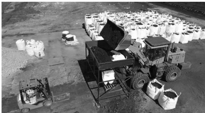
Рис2. Формирование биг-бэгов с углем
