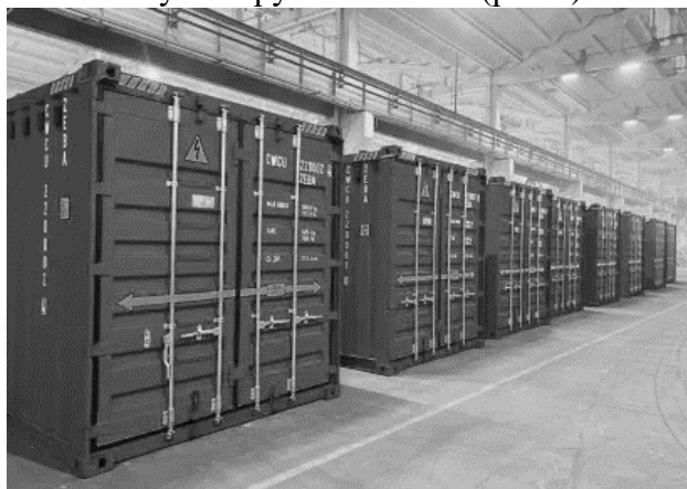
Рис1. Специализированный контейнер с люками и с дверями
