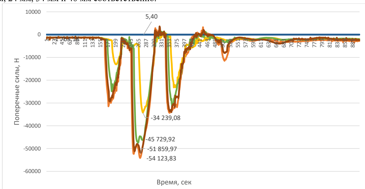
Рис.6. Изменение величины боковых сил в зависимости от величины неровности пути в плане в момент времени 4-8 секунды.
