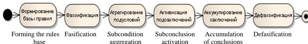
**Рис. 1.** Схема этапов нечеткого вывода
