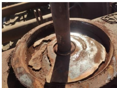
Рис. 10. Изношенный диск Fig. 10. Worn out disk
