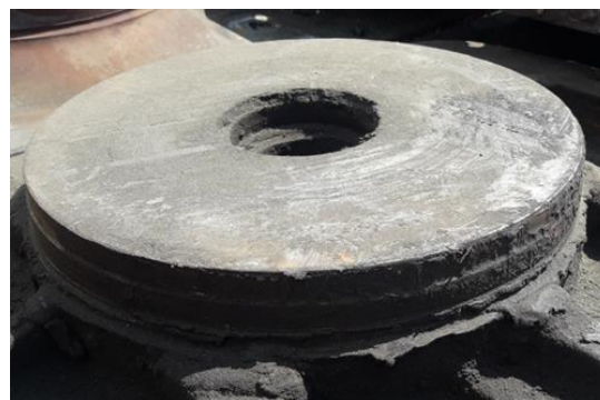
Рис. 8. Пятник с изношенными контактными поверхностями
