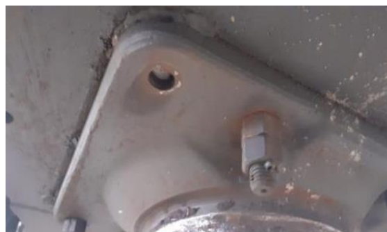
Рис. 9. Обрыв крепежного болта пятника
