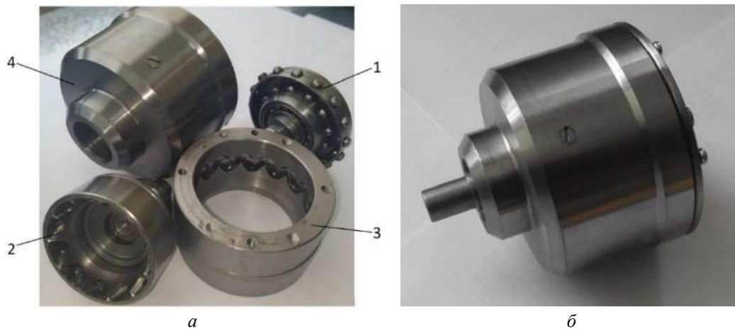
Рис. 3. Экспериментальный образец редуктора со сферической роликовой передачей с двухрядным сателлитом:
