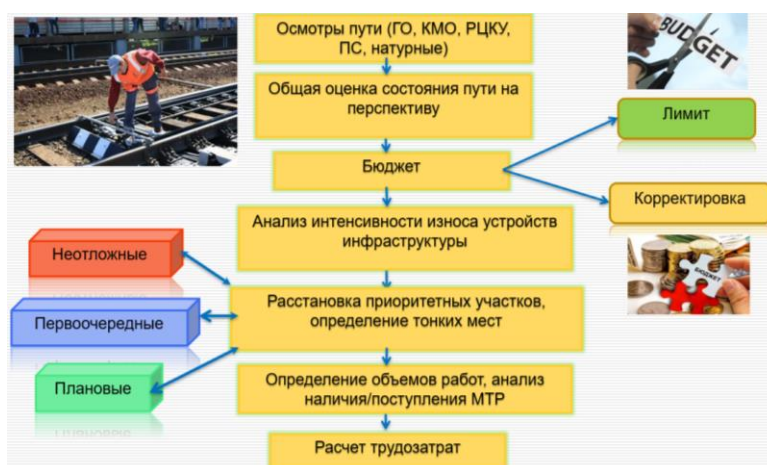
Рис. 1. Схема планирования работ по текущему содержанию пути
