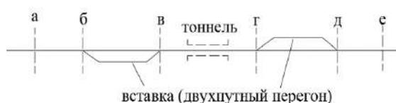
Рис. 9. Схема тоннеля с прилегающими двухпутными перегонами
