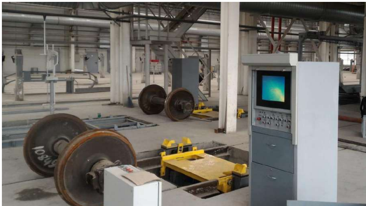
Рис. 2. Система вибродиагностики ОМСД-03
