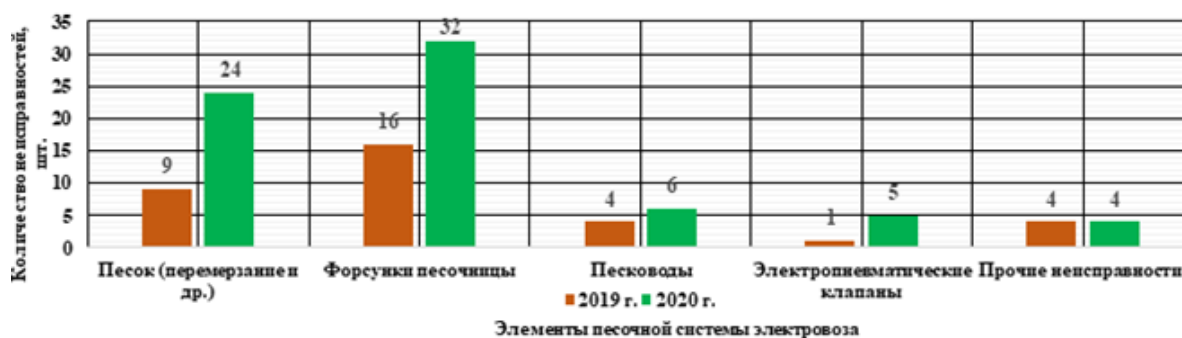
Рис. 4. Причины неисправностей песочной системы электровозов Восточно-Сибирской железной дороги
