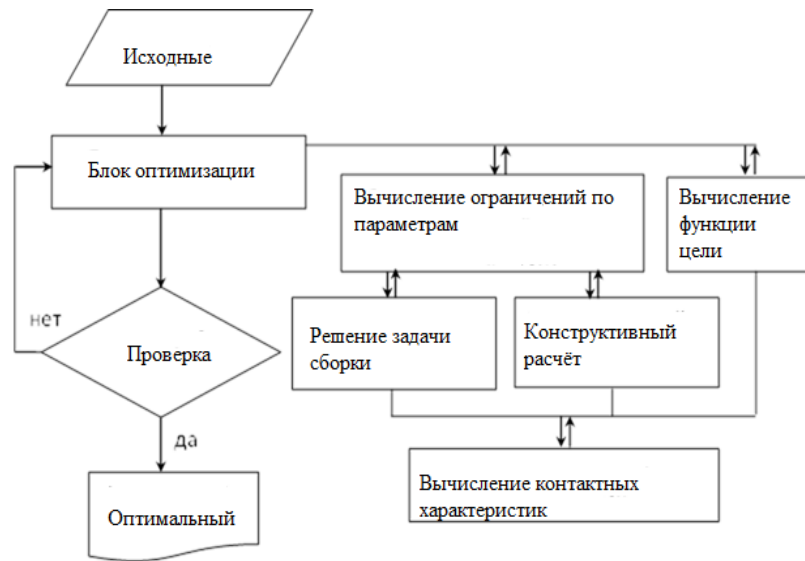
Рис. 1. Взаимосвязь основных блоков алгоритма оптимизации при прямом вычислении функции цели и ограничений
