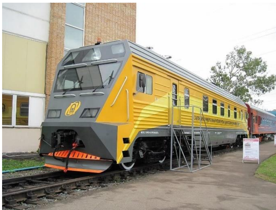
Рис. 1. Самоходный универсальный путеизмерительно-диагностический комплекс «Север»
