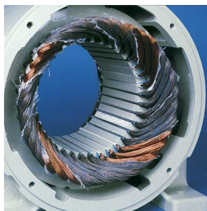
Рис. 6. Обрыв фазы Fig. 6. Phase loss
