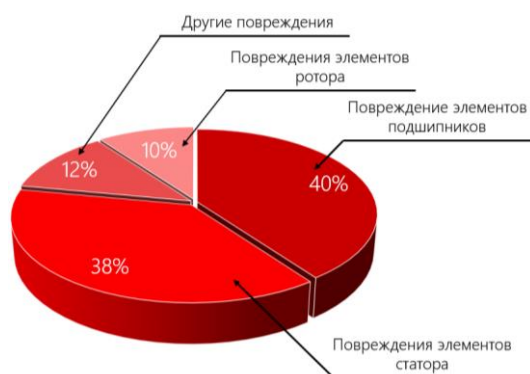
Рис. 5. Статистические данные по неисправностям асинхронных двигателей
