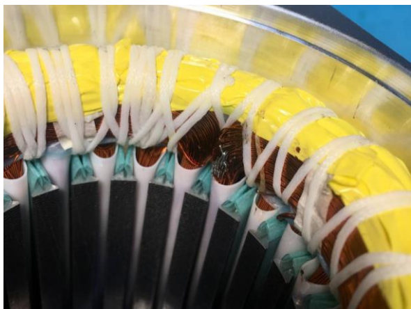
Рис. 16. Межвитковое замыкание на двигателе №3 Fig. 16. Turn-to-turn short-circuit on the motor №3
