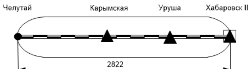
Рис. 5. Схема тяговых плеч на участке Челутай – Хабаровск-II Fig. 5. Scheme of traction arms on the Chelutai – Khabarovsk-II section
