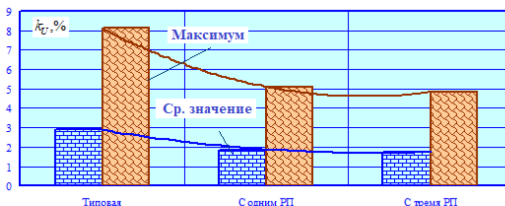
Рис. 16. Максимумы и средние значения суммарных коэффициентов гармоник Fig. 16. Maximum and average values of total harmonic coefficients
