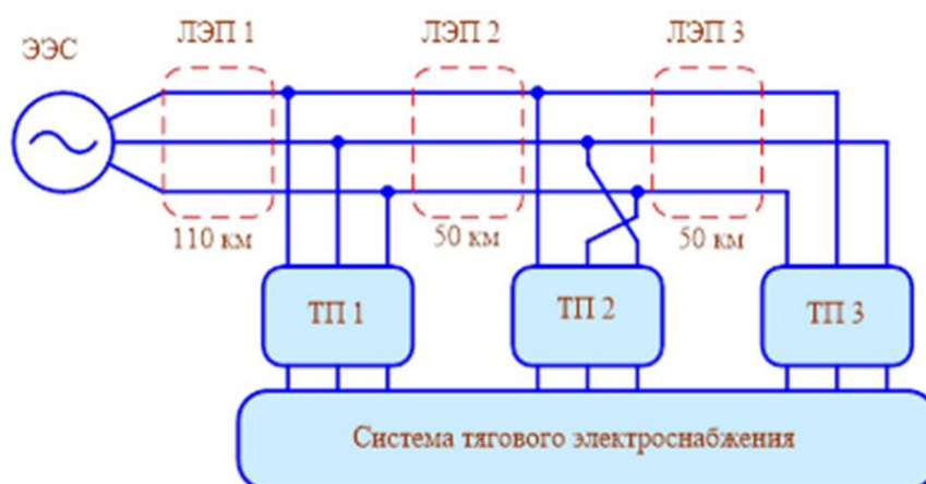
Рис. 1. Схема электрической сети, питающей тяговые подстанции
