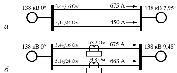
Рис. 2. Схемы сети без устройства распределенной продольной компенсации (а) и с устройством (б) Fig. 2. Schematics of a network without a compact distributed static series compensator (a) and with a compact distributed static series compensator (b)
