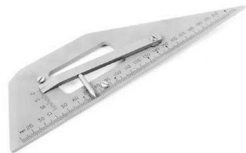
Рис. 3. Шаблон КОР для измерения очертаний и контуров Fig. 3. KOR gauge for measuring outlines and contours
