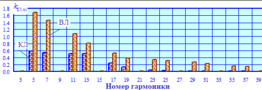
Рис. 13. Спектры гармоник напряжения на шинах 110 кВ ТП 3
