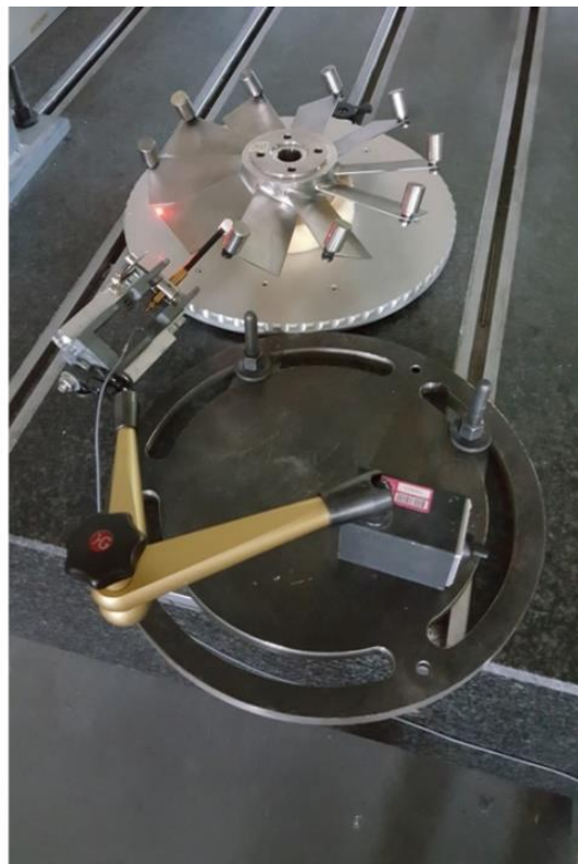
Рис. 5. Экспериментальное исследование динамических характеристик колебаний академического колеса
