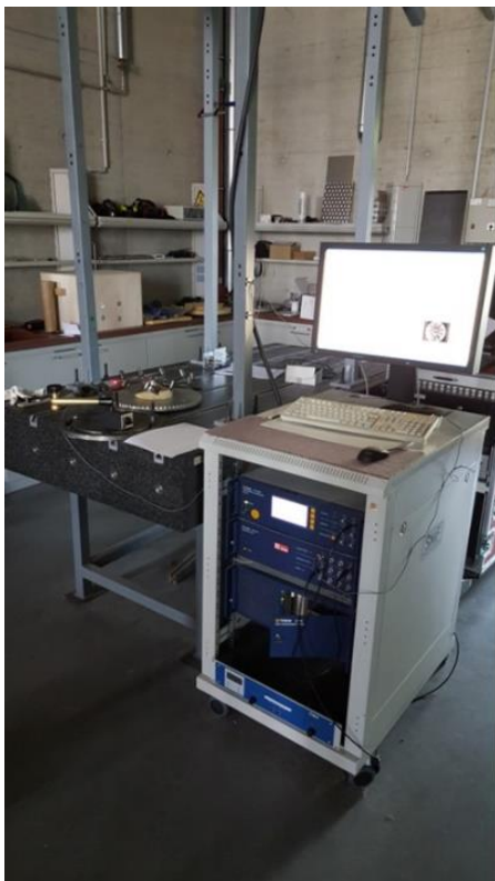
Рис. 5. Экспериментальное исследование динамических характеристик колебаний академического колеса
