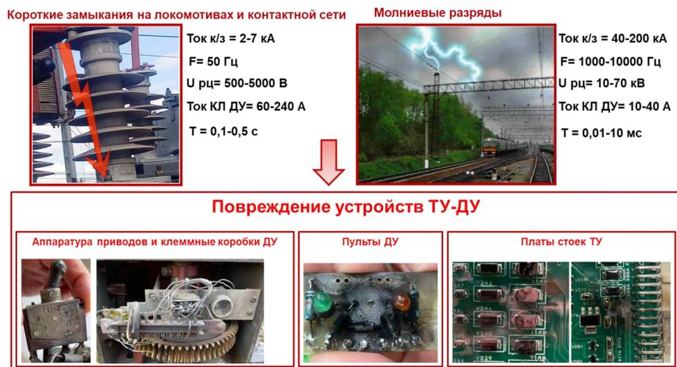
**Рис. 1.** Электрические параметры, сопровождающие повреждения устройств теледистанционного управления
