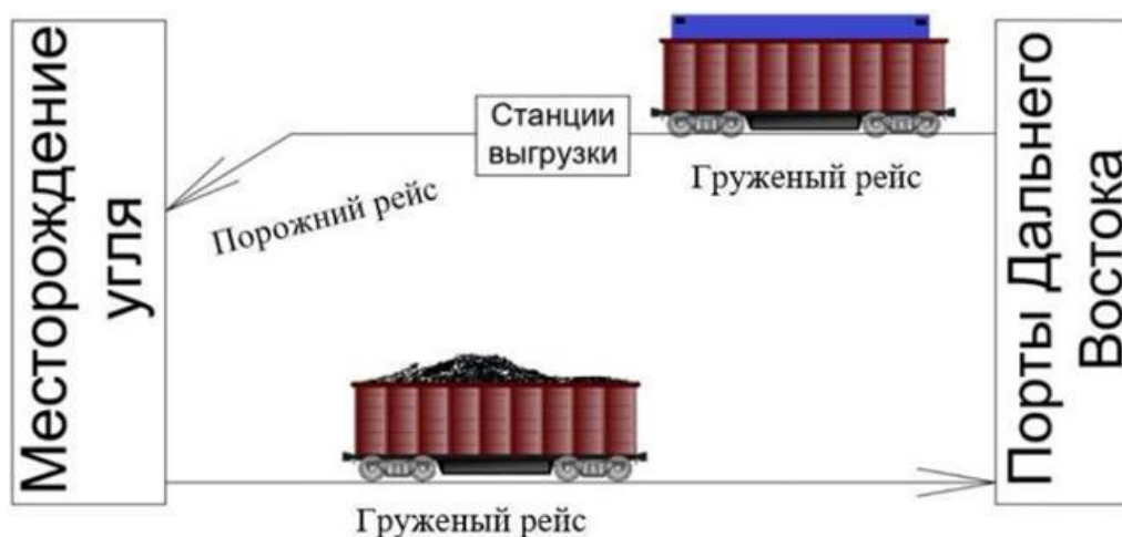
Рис. 1. Логистическая схема перевозки с обратной загрузкой порожнего полувагона контейнером
