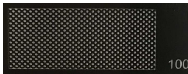
Рис. 7. Растровое изображение с разрешающей способностью 100 dpi Fig. 7. Raster image with resolution of 100 dpi
