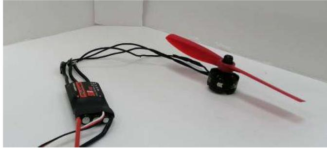
**Рис. 5.** Мотор-регулятор
