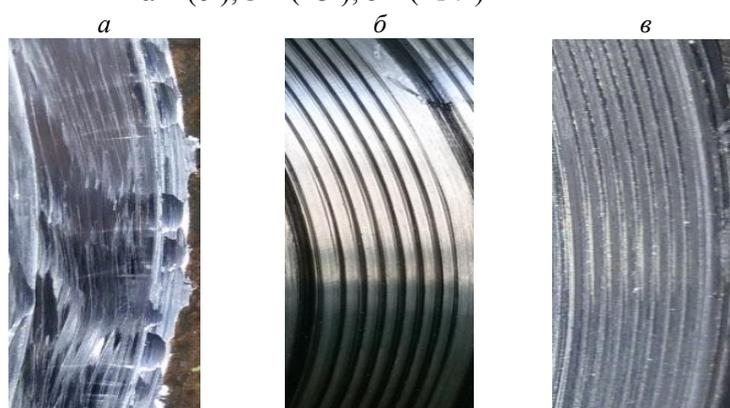
**Рис. 11.** Обработанная поверхность заготовки экспериментальными пластинами с отрицательным задним углом:
