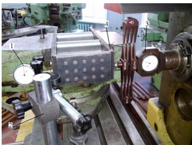
**Рис. 7.** Установка измерения жесткости приспособления:
