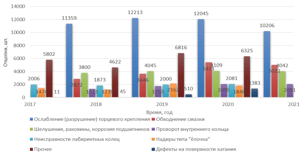
Рис. 5. Отцепки вагонов по неисправностям буксового узла в 2017–2021 гг.
