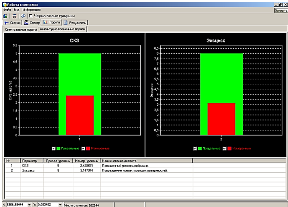
Рис. 3. Пороги для среднеквадратичного значения и эксцесс неисправной буксы
