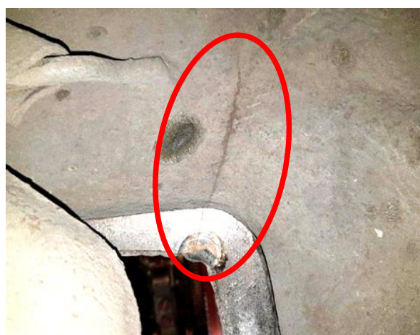
Рис. 3. Трещины в остове тягового электродвигателя НБ-514:
