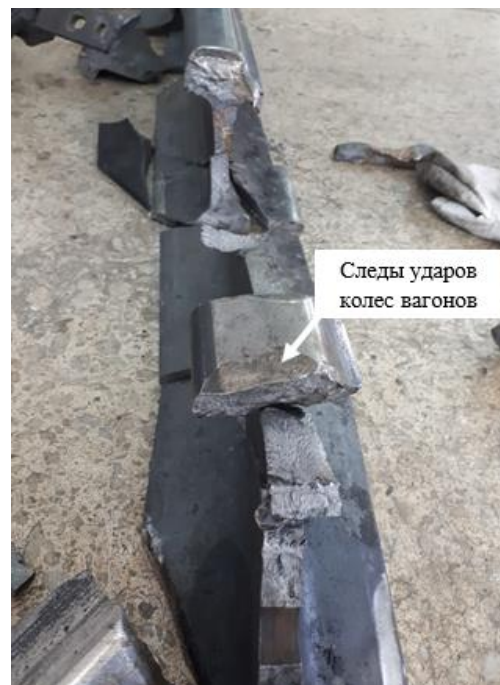
Рис. 1. Фрагменты разрушения рельса после схода (16 марта 2021 г.)
