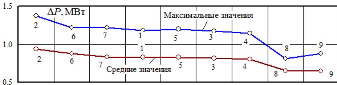
Рис. 16. Потери мощности в линии электропередачи 1 (цифровые обозначения соответствуют рис. 7)
