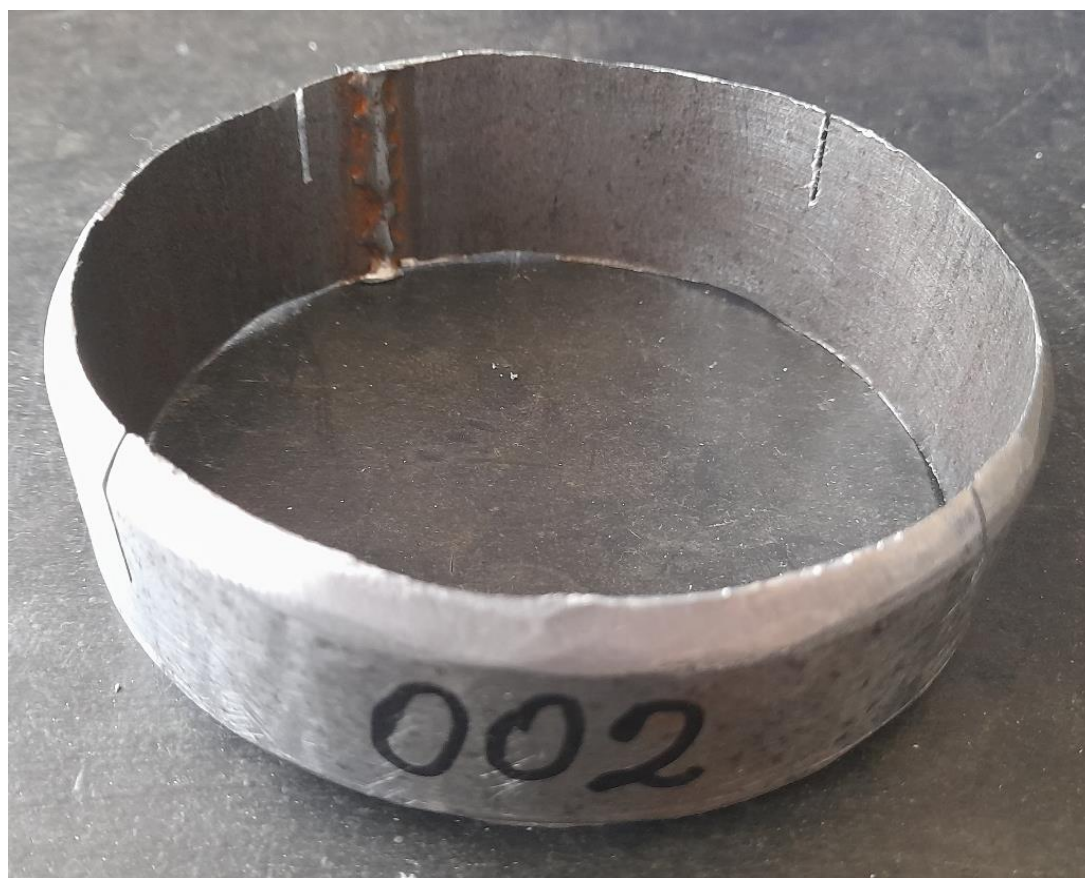
Рис. 5. Фотография детали № 002, деформированной ножовкой по металлу
