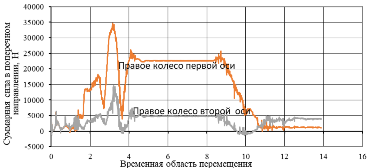
Рис. 1. График динамического движения вагонов в кривом участке пути с просадкой Fig.1. Graph of the dynamic movement of wagons in a curved track section with a drawdown
