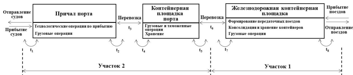
Рис. 4. Технологическая схема работы Пусанского транспортного узла:
