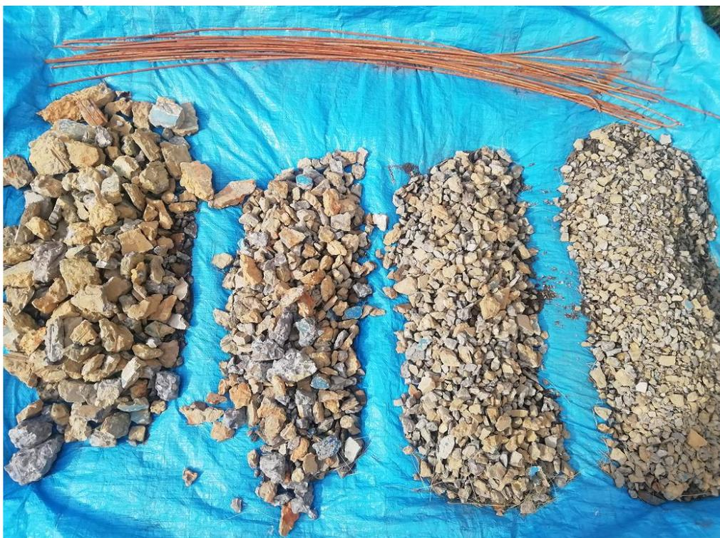
Рис. 4. Дробленный бетон и арматура
