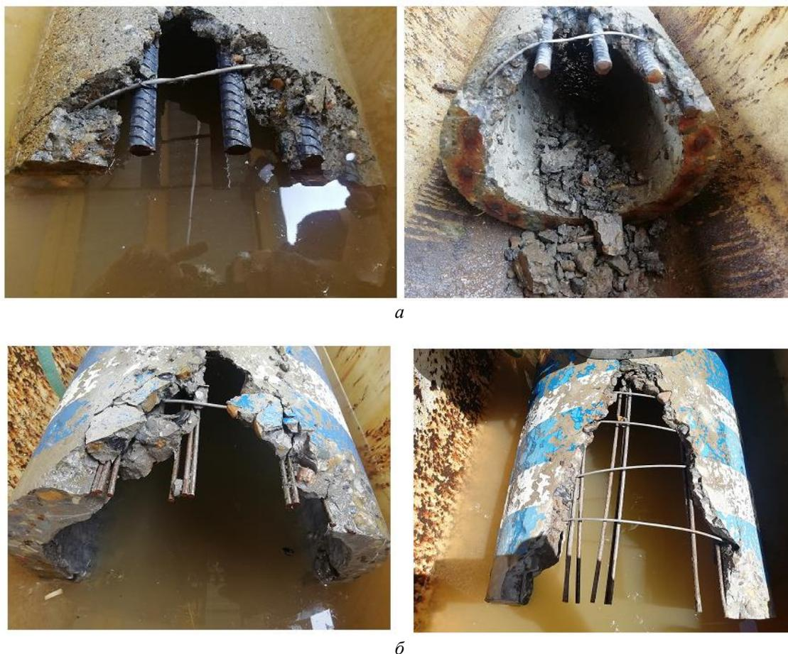
**Рис. 3.** Процесс отслоения бетона от арматуры после приложения испытательных воздействий к железобетонной опоре типа:
