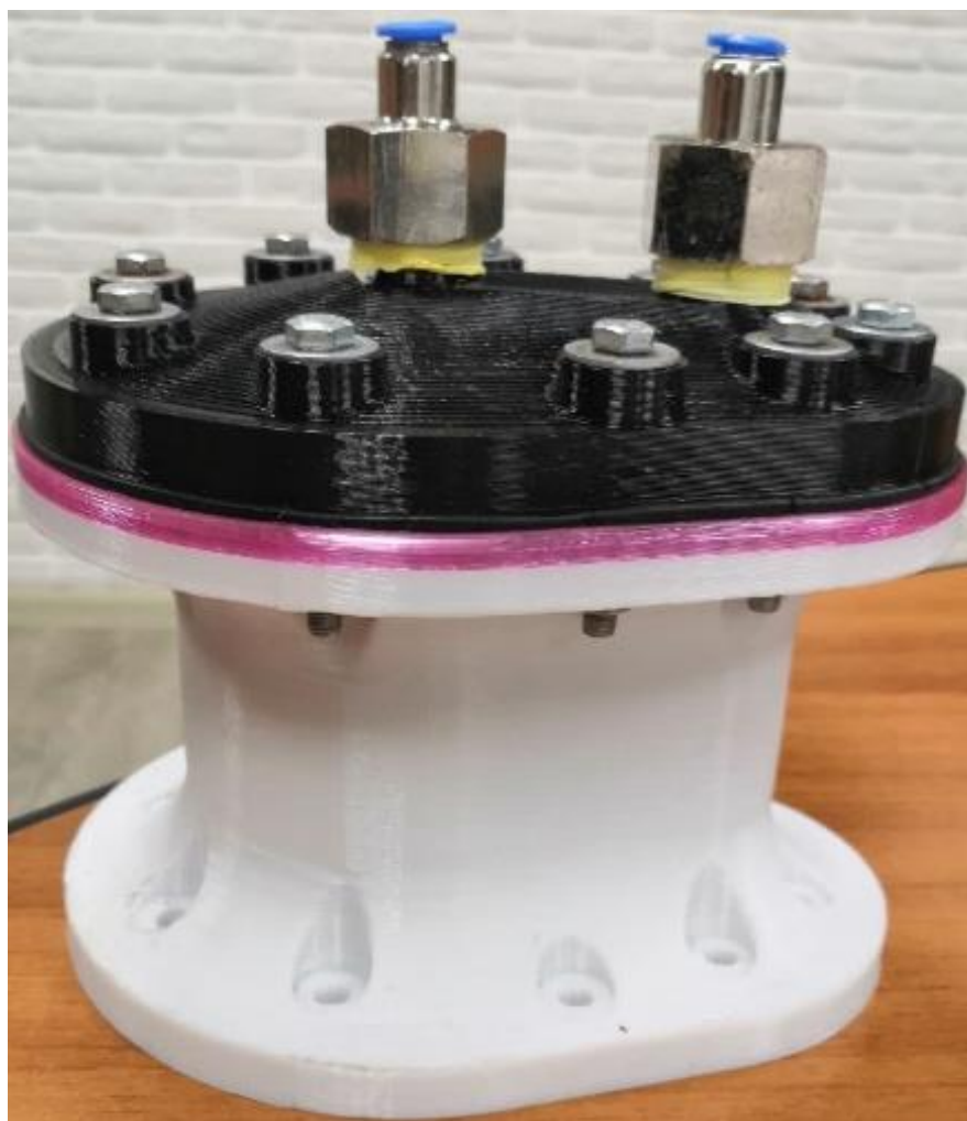
Рис. 9. Модернизированная часть корпуса пневматического редуктора
