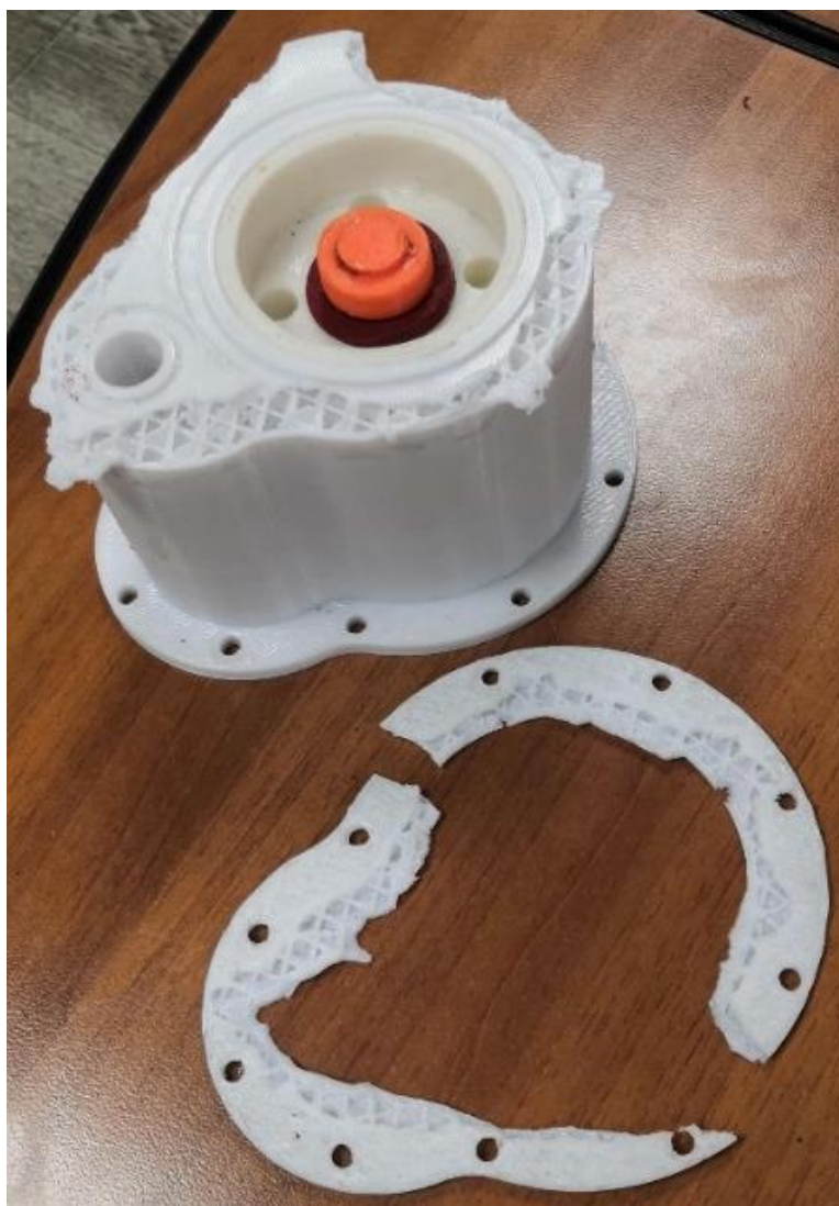
Рис. 6. Разрушение корпуса редуктора в месте примыкания фланцев к основному телу Fig. 6. Destruction of the gearbox housing at the junction of the flanges to the main body
